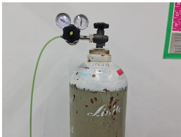
6.7.2. ปิดวาล์วที่ถังไนโตรเจนเพื่อป้องกันการ Leak
